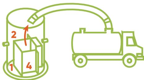
Откачайте осадок со дна 1,2 и 4 отсеков (ассенизаторской машиной или самостоятельно с помощью дренажного насоса). При этом если вы откачаете ил целиком 4 камере, то станция будет выходить на нормальный режим работы еще две недели, поэтому рекомендуется откачивать только 2/3 скопившегося в камере 4 ила.
