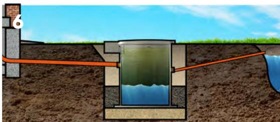
Финальная засыпка песком: уплотнение слоёв через каждые 30 см посредством проливки водой, одновременное заполнение водой БиоДевайса.
