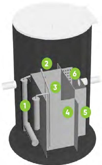
1 блок: первичный отстойник. Механическая очистка – удаление взвешенных частиц (мусора, песка и т.д.), сбраживание ила, при котором извлекается легкоокисляемая органика, необходимая для процесса денитрификации.
