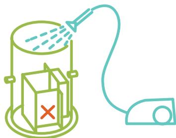
Промойте стенки всех камер (кроме четвертой) водой под напором.
