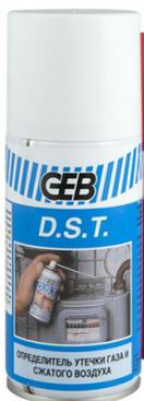
который необходимо нанести на места возможных утечек. Если пузыри не увеличиваются в размерах - соединение герметично. Избегайте попадания брызг на аккумулятор и другие электрические части. При необходимости тщательно просушите эти места.
